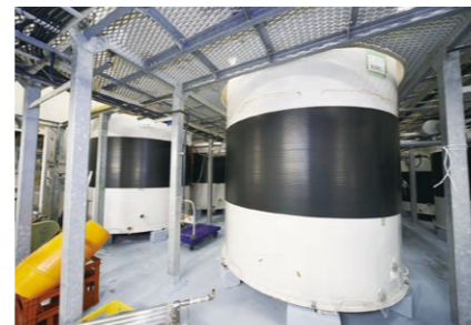
酒造メーカー 仕込タンクの発酵熱の冷却にブラインチラーを採用。
