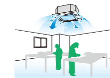
S-ラウンドフロータイプ 全周吹出しで風速を抑えるためドラフトを低減し作業者の快適性を向上 18℃運転 ▶ 体感温度 14~14.5℃ 体感温度を1~1.5℃改善
