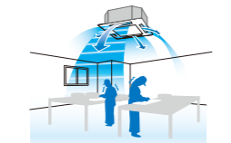
一般的な4方向カセット 吹出口近辺の頭上でドラフトによる不快感がある 18℃運転 ▶ 体感温度 13℃
